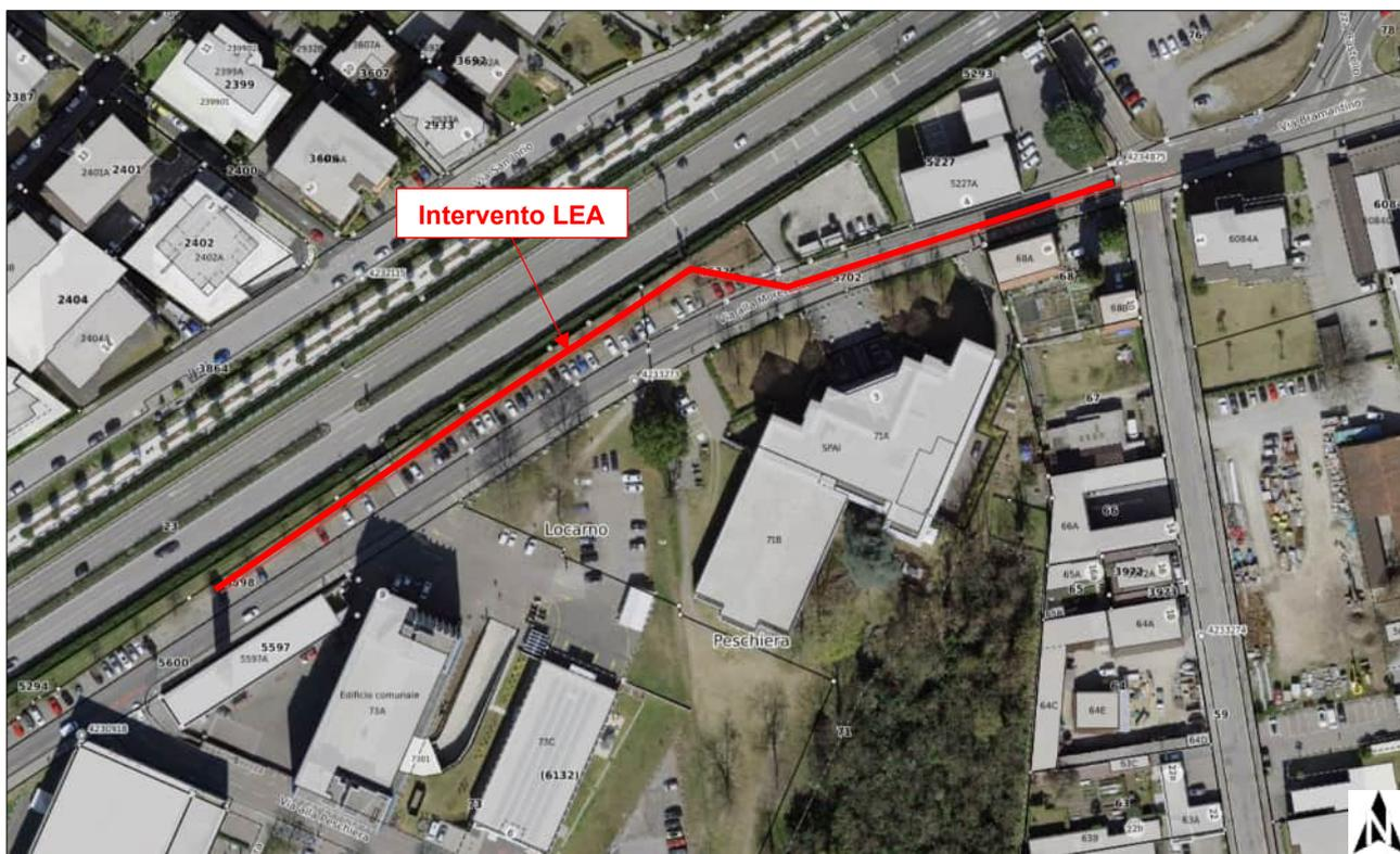
L'intervento in Via alla Morettina è stato realizzato in conformità al nuovo Piano Generale dell'Acquedotto (PGA), con l'obiettivo di migliorare l'infrastruttura idrica e garantire una maggiore affidabilità della rete. Il progetto ha previsto la sostituzione della vecchia condotta in ghisa grigia (GG) di diametro 300 mm con una nuova condotta in ghisa duttile di diametro 400 mm, per una lunghezza di circa 240 metri lineari.
