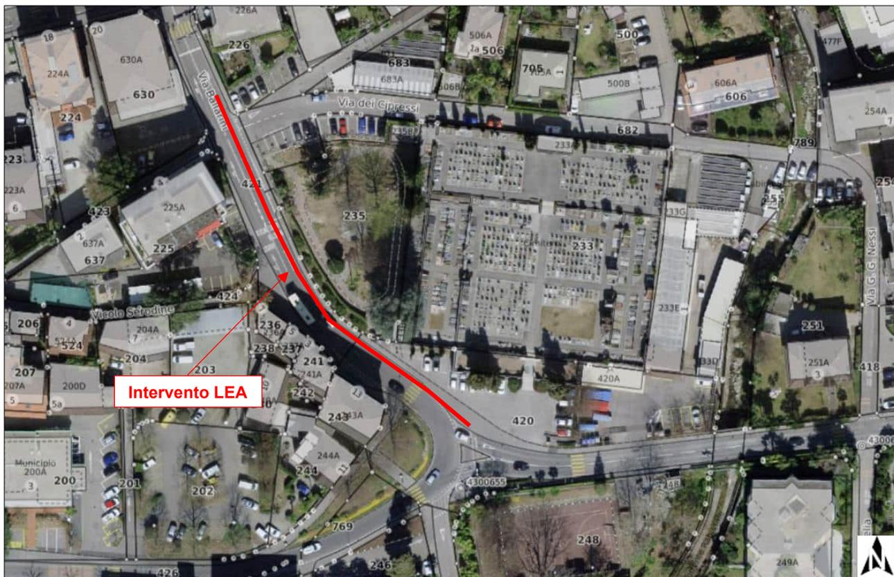
L'intervento in questione rientra in un progetto più ampio di adeguamento della rete idrica nel comprensorio di Muralto, in linea con il nuovo Piano Generale dell'Acquedotto (PGA). L'obiettivo principale è stato la sostituzione della vecchia condotta in ghisa grigia da 200 mm, installata negli anni '60, con una nuova tubazione in ghisa duttile di pari diametro, per una lunghezza complessiva di circa 115 metri lineari.
