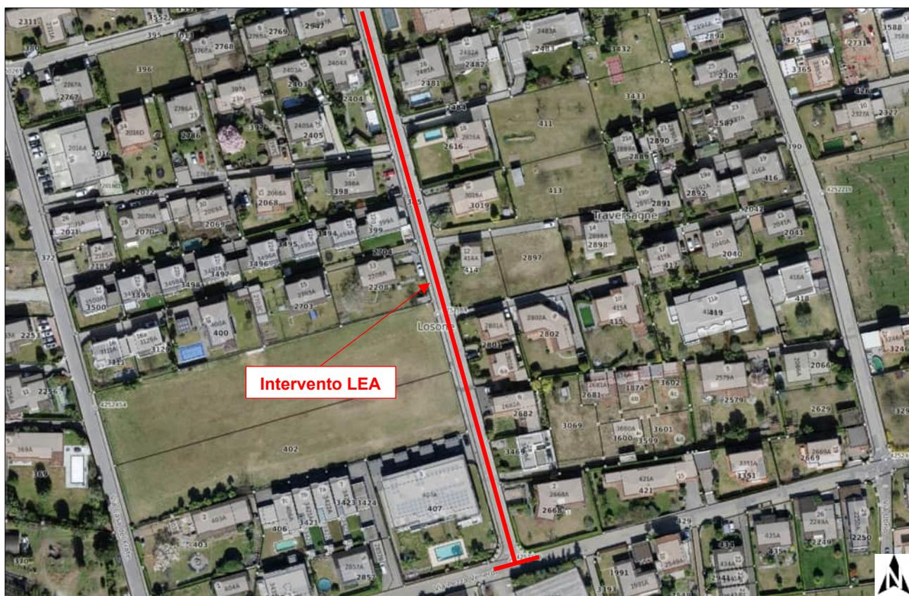
Le condizioni della rete idrica in Via Pisone hanno reso necessario un intervento di sostituzione e potenziamento, a seguito delle ripetute perdite registrate negli ultimi anni. Il progetto ha previsto l'eliminazione della vecchia tubazione in ghisa grigia da 80 mm, risalente agli anni '50, e la posa di una nuova condotta in ghisa duttile da 100 mm, per una lunghezza di circa 225 metri lineari.
