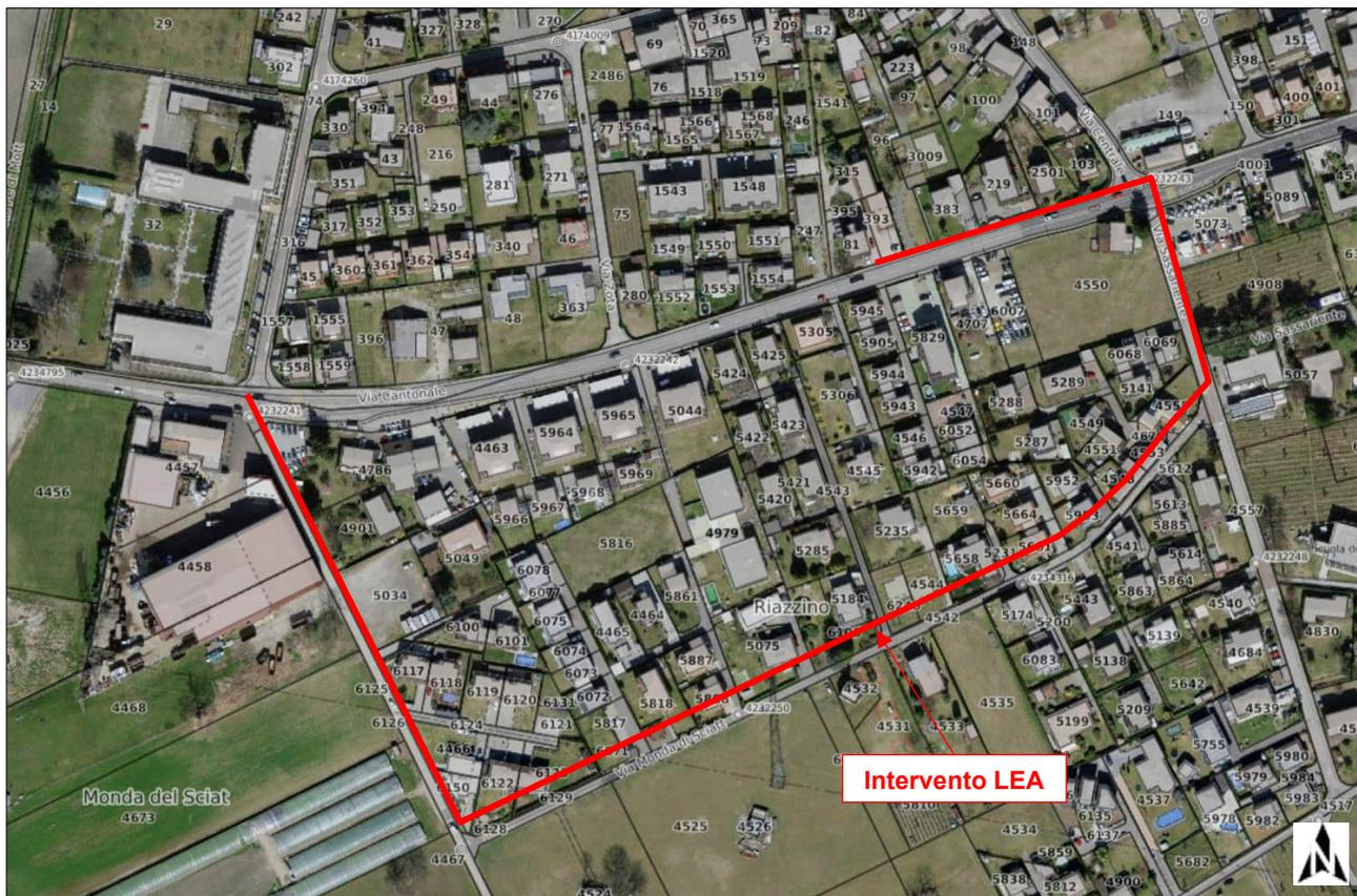
L'intervento ha avuto l'obiettivo di sostituire e potenziare le infrastrutture idriche esistenti, garantendo un servizio più efficiente e migliorando gli standard igienici della rete. In particolare, il progetto ha previsto l'abbandono della vecchia condotta lungo la strada cantonale, in favore di una nuova infrastruttura più performante e adeguata agli attuali requisiti tecnici.
