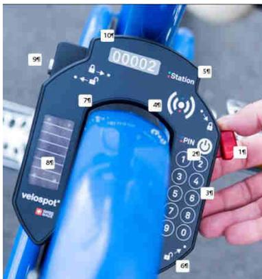
1. → Verrouillage automatique à l'ouverture—manuel à la fermeture!†
