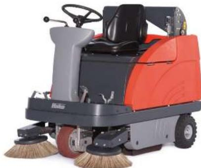
*Figura 7: Spazzatrice professionale aspirante, dim. indicative 1.5 x 1 x 1.3 metri (modello indicativo)*
