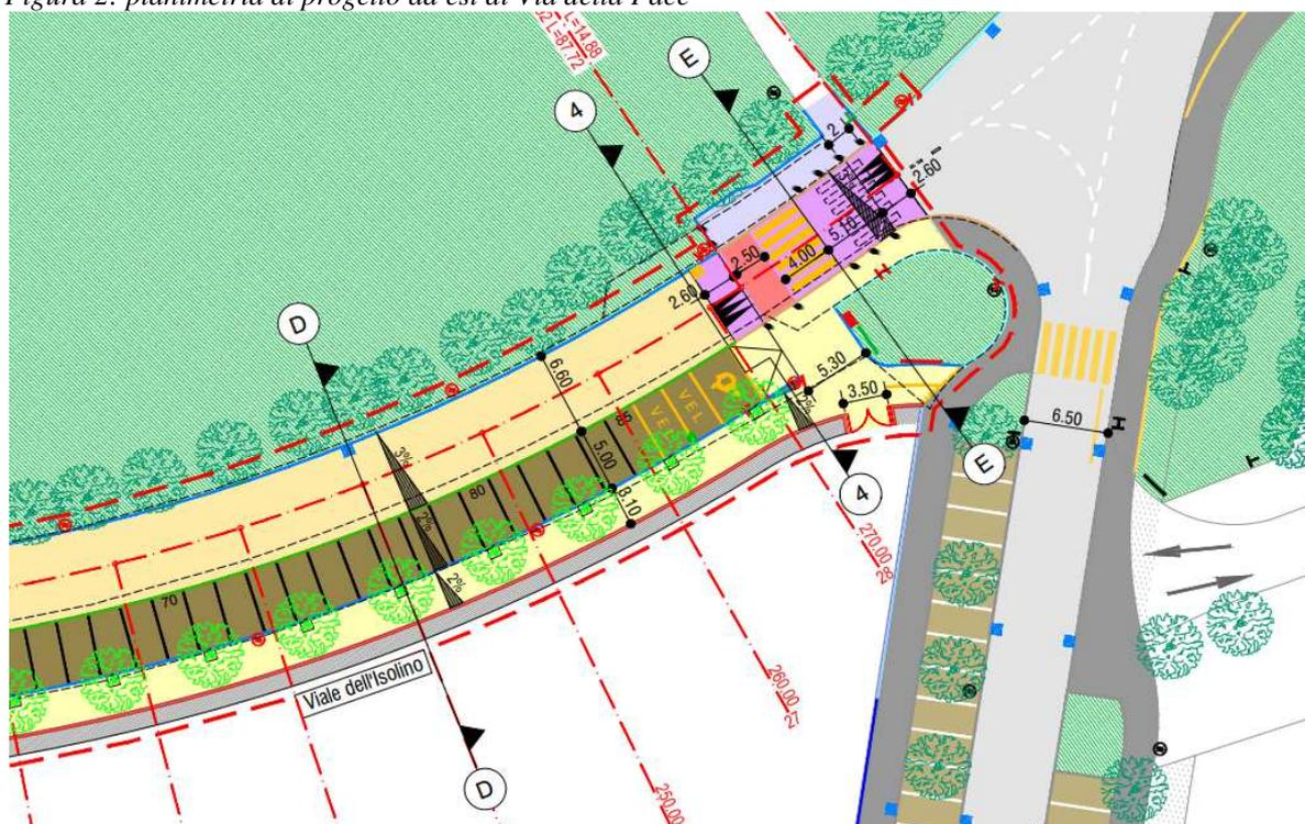
Verso Via della Posta e nella zona centrale della tratta, sono previsti alcuni posteggi moto su pavimentazione bituminosa mentre i posteggi auto saranno realizzati con materiale fresato e/o ghiaia. Nel progetto si prevedono due nuovi parchimetri collettivi posizionati alle estremità della tratta e uno in posizione centrale.
