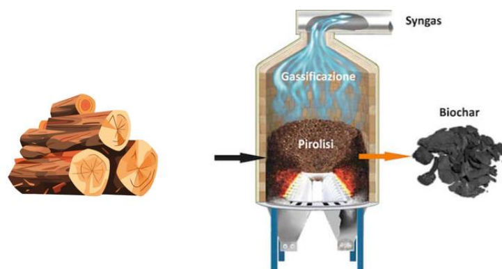
Figura 2: schema del processo di pirolisi
