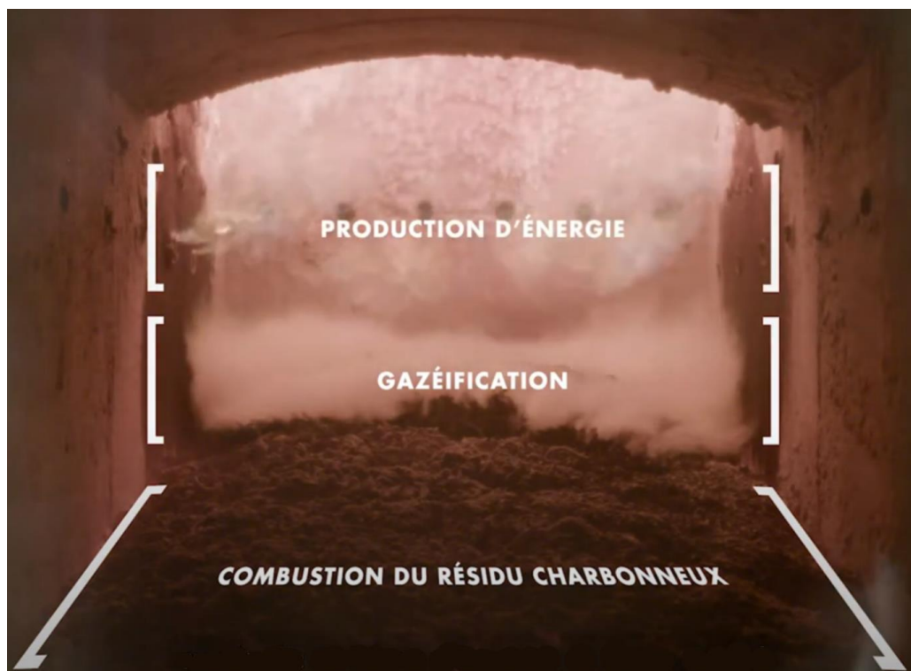
Figura 4: schema gassificazione all'interno della camera di combustione
